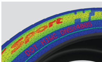
Gescannter Reifen mit identifizierbaren Merkmalen
